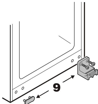
**9.** Unteren Scharnierwinkel umsetzen.
