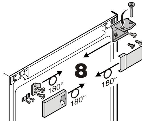
**8.** Die oberen Scharnierteile umsetzen
